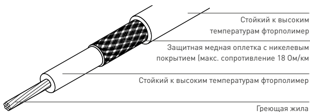
Рис. 1.: Типичная конструкция кабеля с полимерной изоляцией
