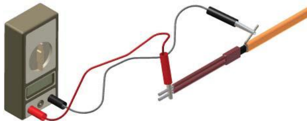
Рисунок 4 – Схема подключения при проверке сопротивления изоляции
